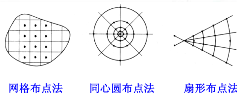
图2 网格布点、同心圆布点以及扇形布点法的原理图
