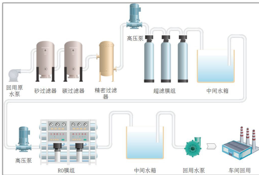
图2 中水回用技术工艺流程图
