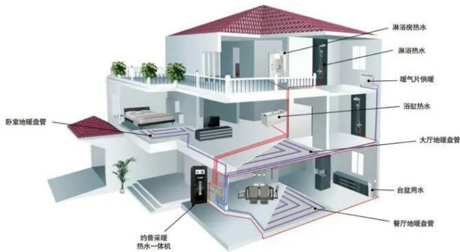
图1 采暖技术的基本构造
