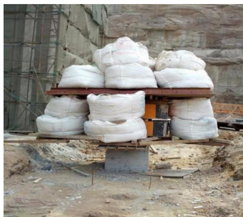
图 4 双倍承载泡水试验
