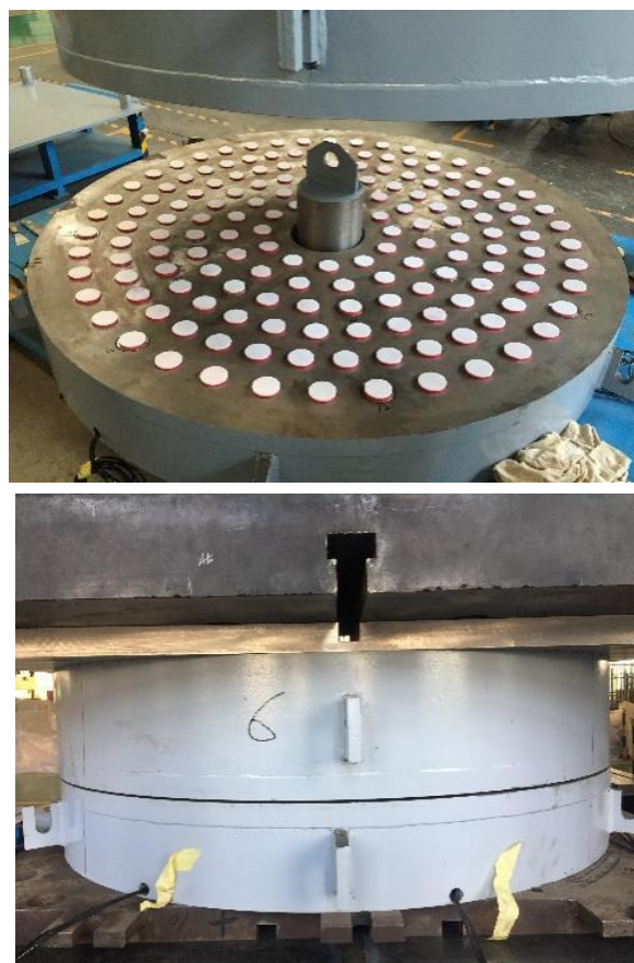
图 7 测力球铰结构与测试图
